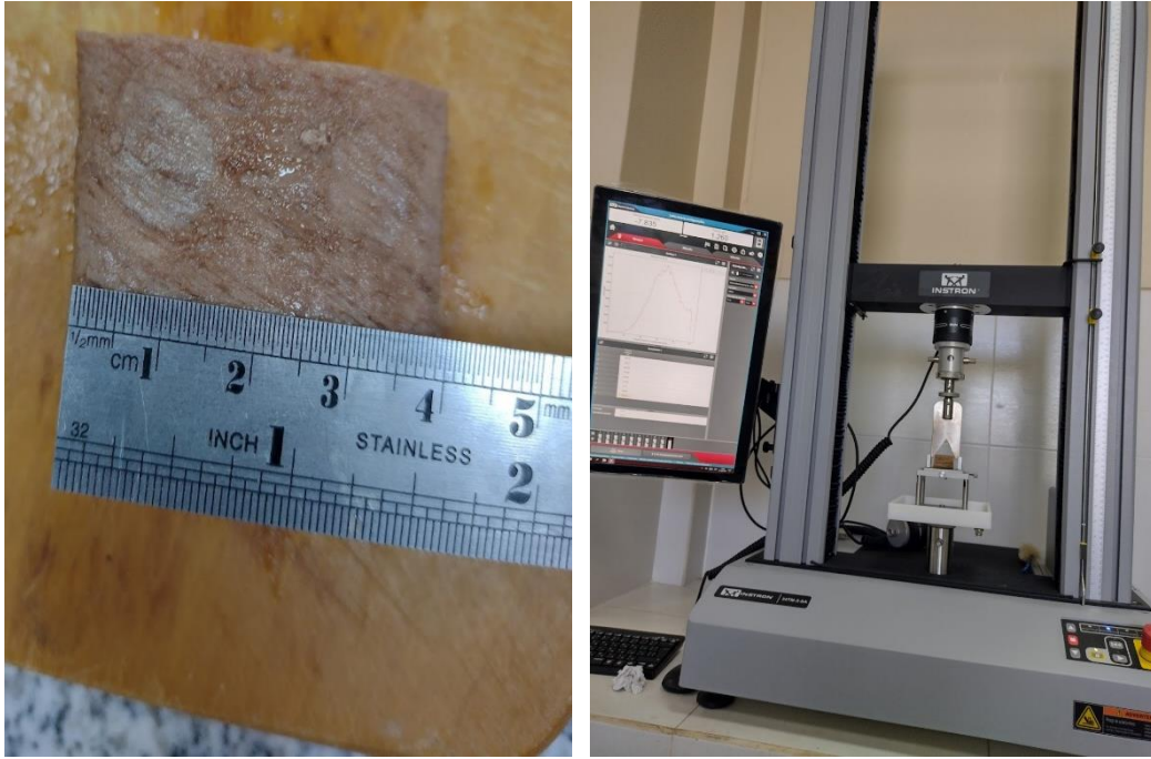
Figura N° 13: Toma de medidas de muestra de carne de alpaca a analizar y texturómetro INSTRON 34 TM-5-SA.
