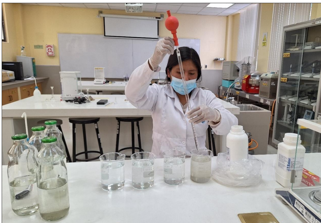
Foto 9 Digestión de muestras de agua con peróxido de hidrógeno al 30%
