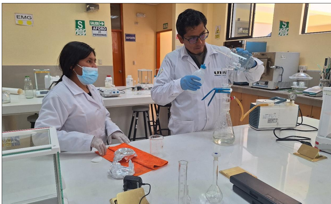
Foto 10 Filtrado de muestras luego de la digestión con H_2O_2 30%
