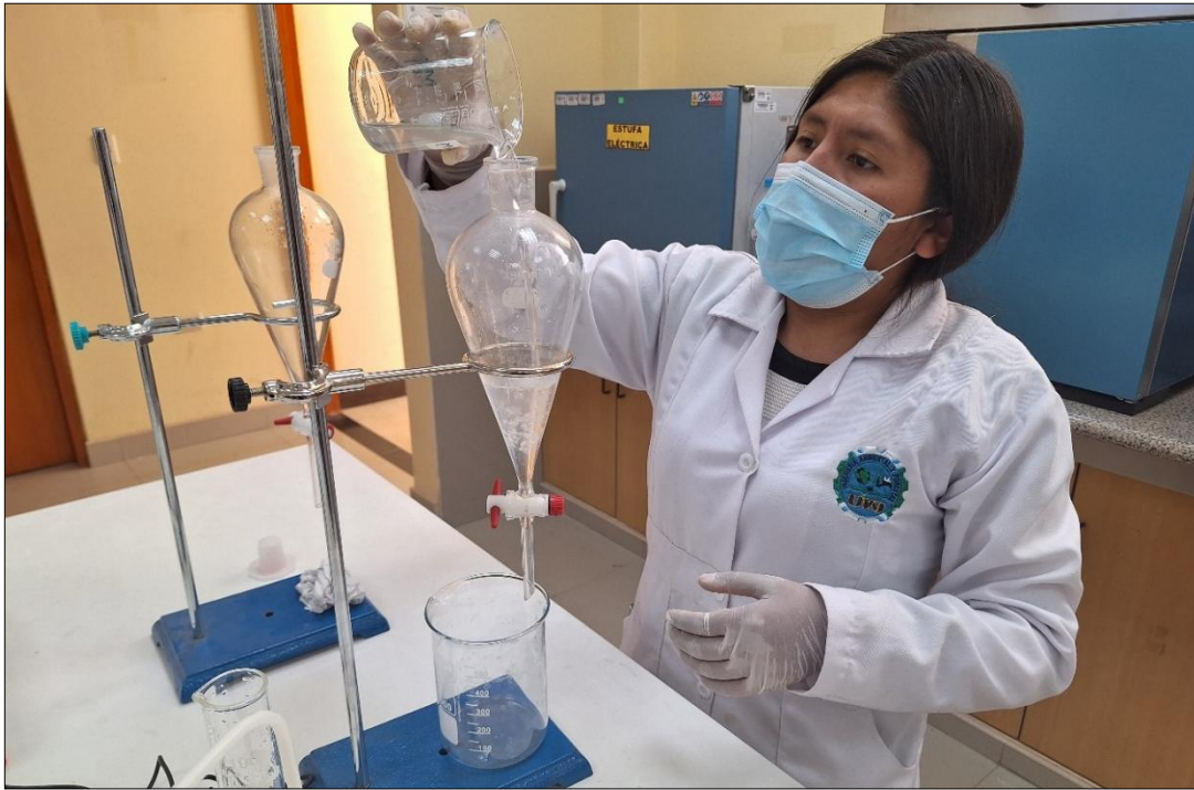
Foto 11 Muestras luego de la digestión, para la separación por densidad con NaCl
