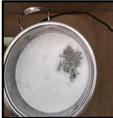
Figura 29. Etapa de mezclado y ebullición de las saponinas para la fabricación de los detergentes líquidos biodegradables
