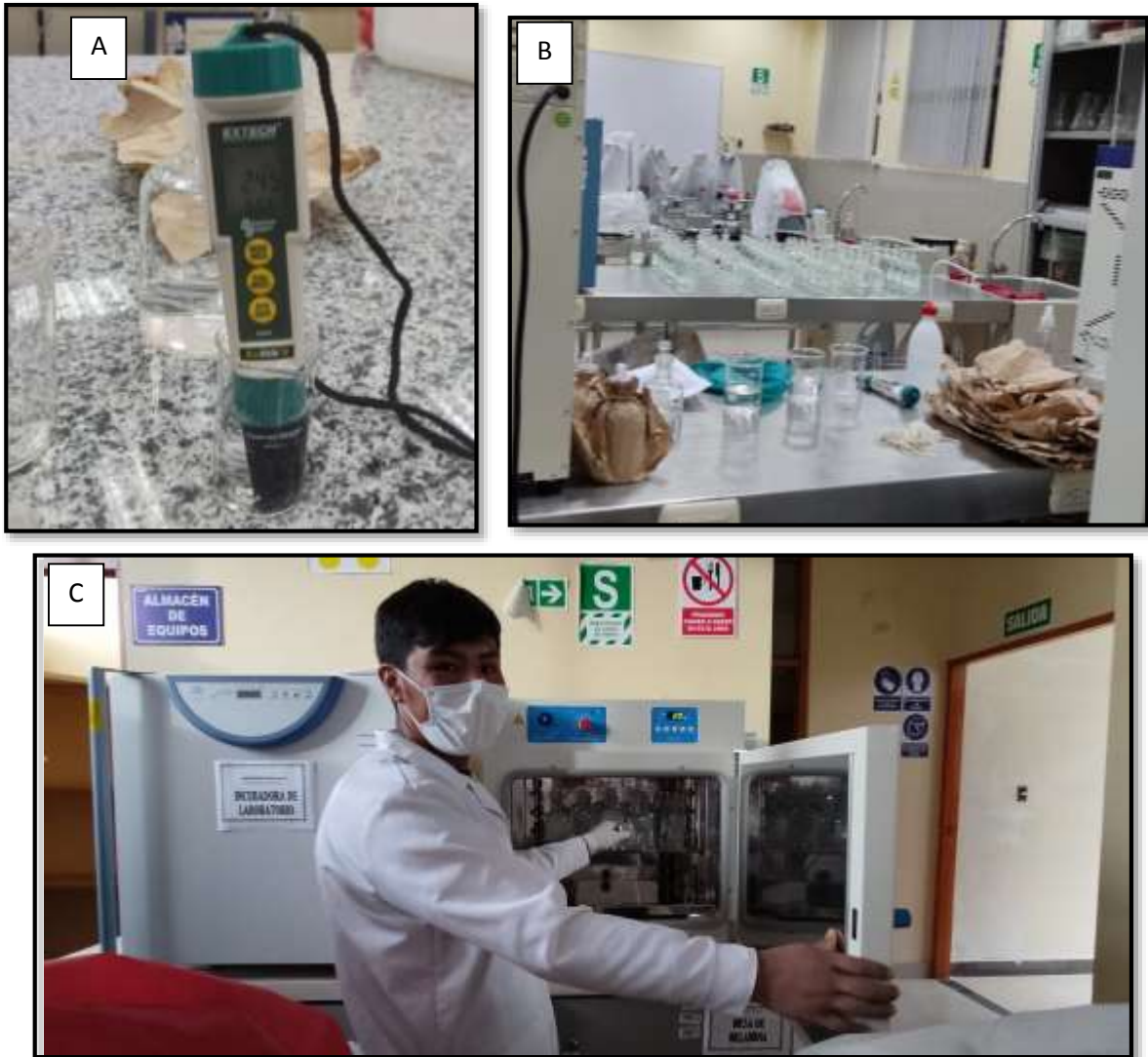
Figura 26. Análisis de DBO 5 de los procesos de biodegradación de materia orgánica A: Medición de oxígeno disuelto final B: frascos Winkler C: extracción de muestras luego de la inoculación.
