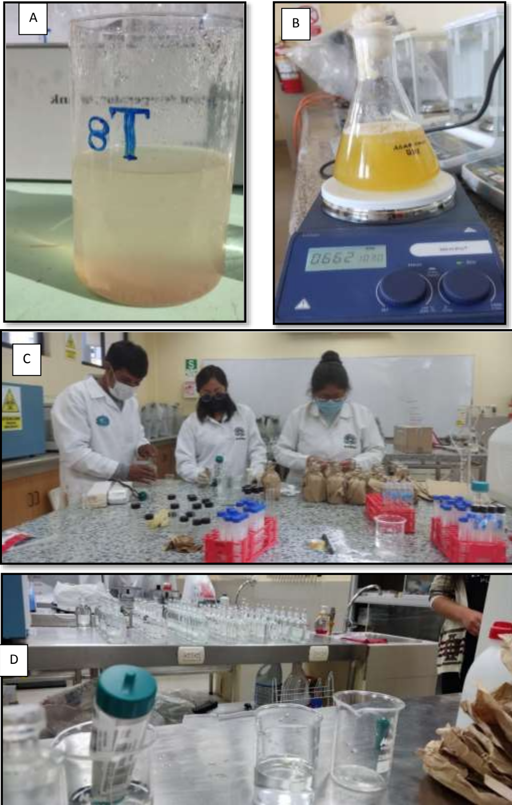
Figura 25. Determinación de la DBO 5 A: Sedimentación de la muestra B: Preparación de inóculo microbiano C: Lectura de muestras D: Medición del oxígeno disuelto final.
