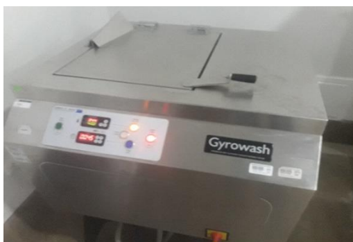
Figura 8: Máquina Gyrowash para las pruebas de lavado
