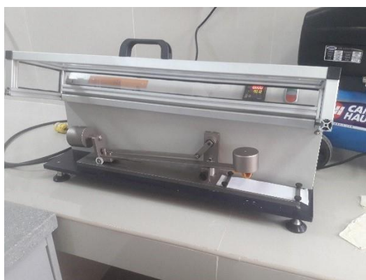
Figura 15: Abrasimetro para las pruebas al frote.
