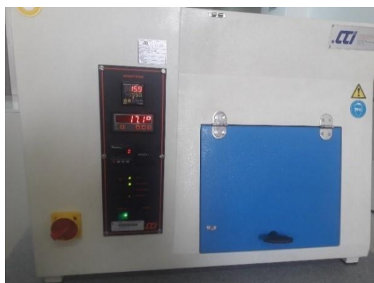
Figura 17: Cámara Xenoterm para las pruebas de solidez a la luz.
