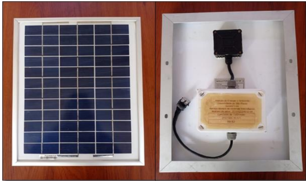
Figura 18. Celda calibrada para medir irradiancia (Fuente propia).
