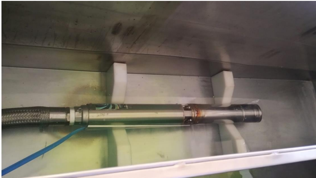
Figura 74. Módulo de del banco de pruebas con fluido del grifo más el aditivo (antioxidante). (Fuente propia)
