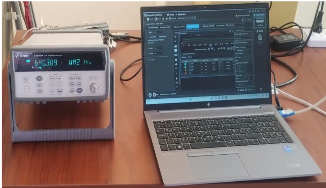
Figura 17. Datalogger Keysight Agilent 34970 a (Fuente propia).
