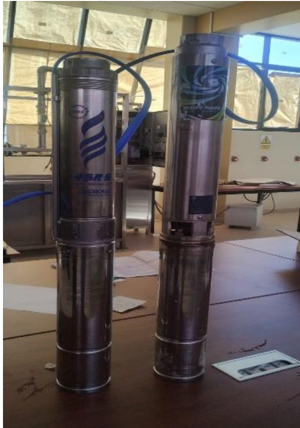
Figura 19. Bombas centrífugas sumergibles de 2HP utilizadas en el estudio (Fuente propia).
