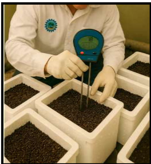
Imagen 18. Proceso de medición de parámetros físicos y químicos durante el proceso de humificación.
