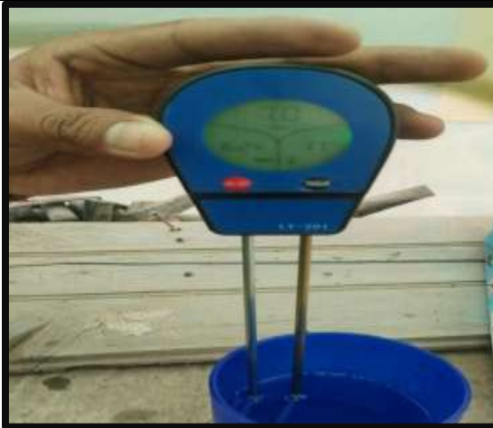
Imagen 12. Calibración de medidor de suelo LY-201.
