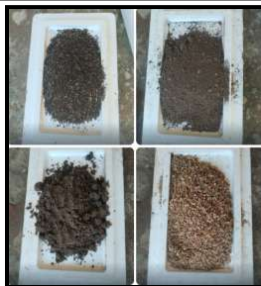
Imagen 19. Preparación y rotulación de muestra para enviarlo a analizar al laboratorio una vez finalizado el proceso de humificación.
