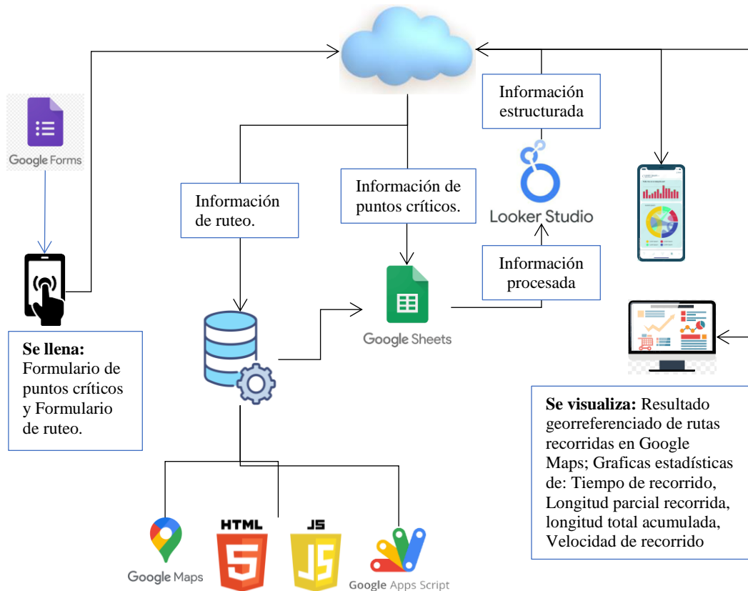
Figura 4. Diagrama del flujo de datos, procesamiento y presentación de información.
