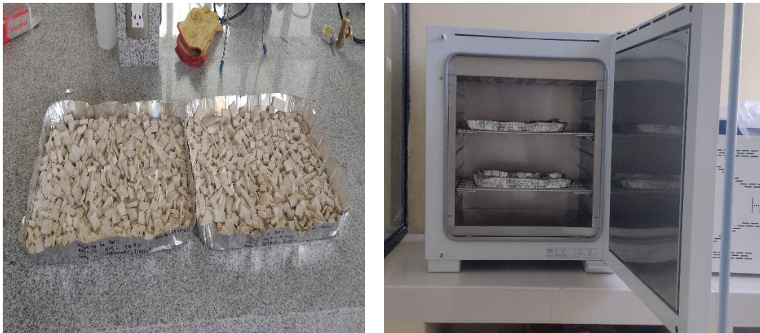
Figura 3. Huesos vacunos reducidos a segmentos pequeño y secado en la estufa eléctrica a 105 °C
