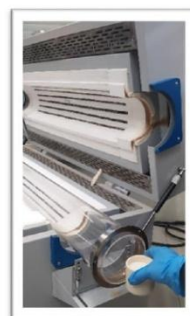
Fig. 3 Montaje de crisol en el horno
