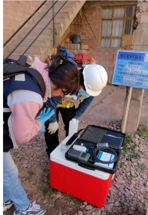
Figura 7. Muestreo de las aguas subterráneas MA001 y MA003
