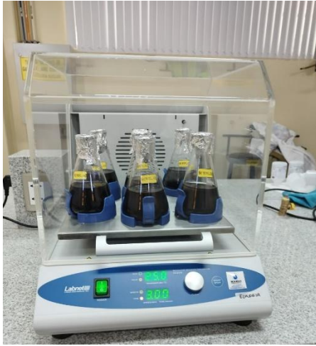
Figura 5. Tratamiento de las soluciones a través de procesos de adsorción discontinua
