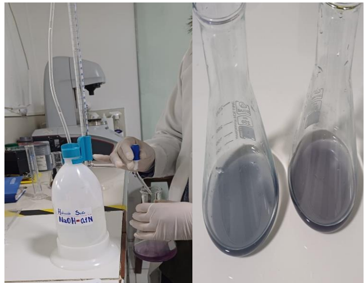
Titulación de Mashua atomizada previamente diluida para determinar la acidez
