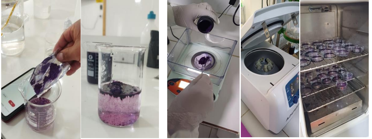
Determinación de humectabilidad de las microcápsulas de antocianinas de mashua.
