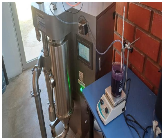
Proceso de atomizado del extracto acondicionado.
