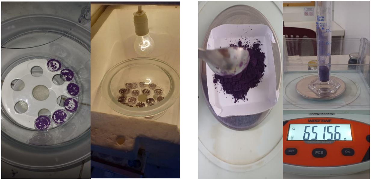
Determinación de higroscopicidad de las microcápsulas de antocianinas de mashua.
