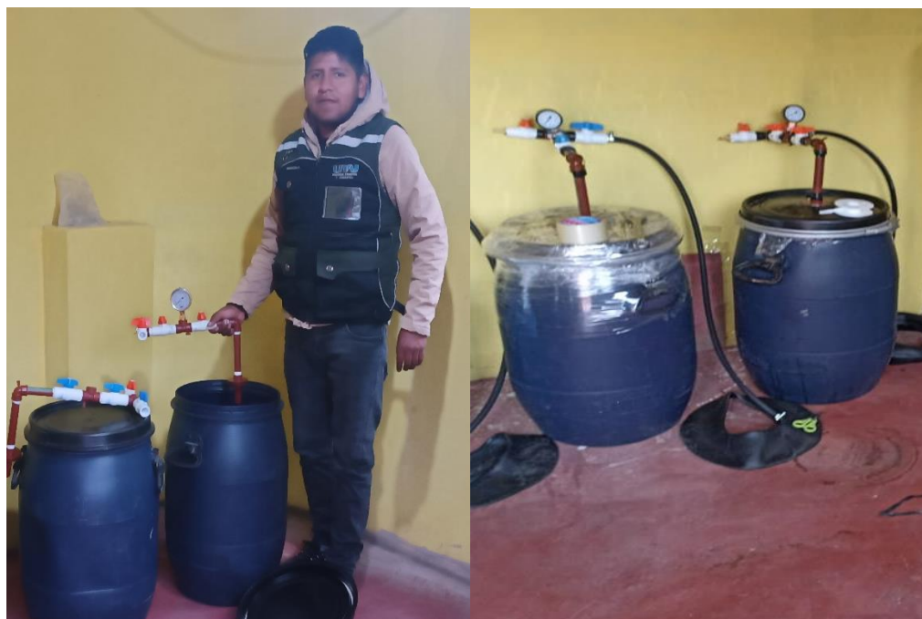
Figura 12 Armado de biodigestores
