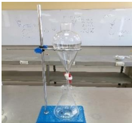
Acondicionamiento del equipo de decantación.
