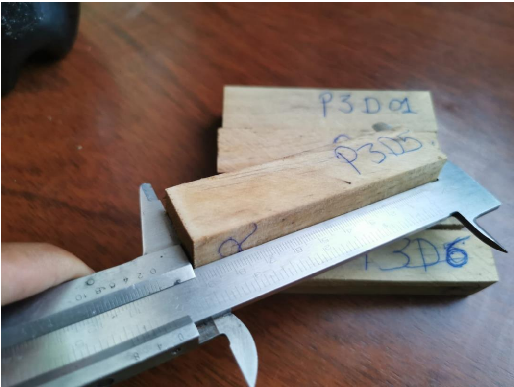
Anexo 2. 4 Toma de medida para la contracción longitudinal
