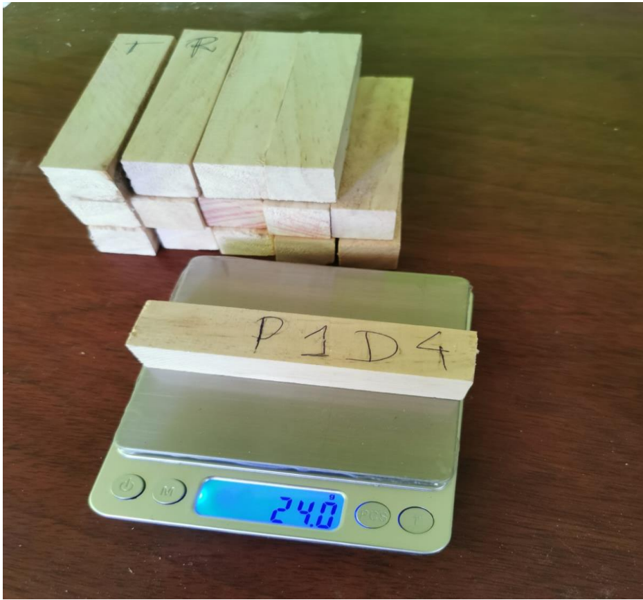
Anexo 2. 1 Pesaje de las probetas para el ensayo de contenido de humedad
