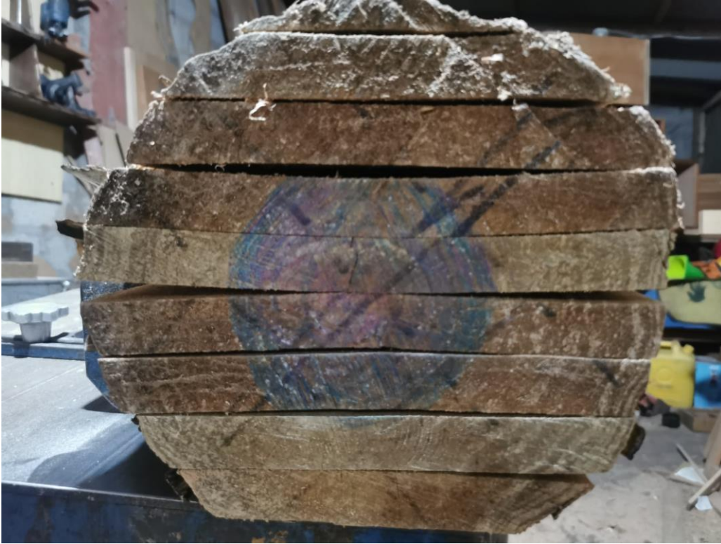
Anexo 1. 5 Seccionamiento de madera rolliza
