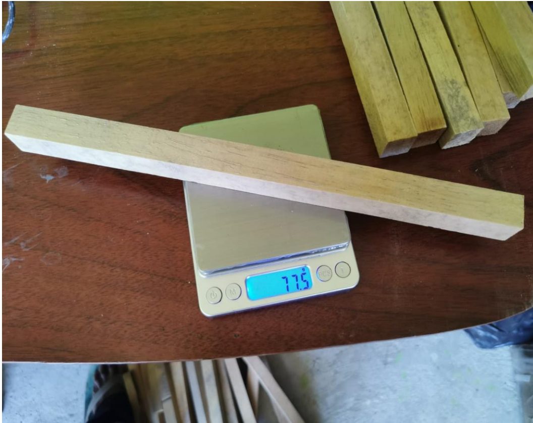
Anexo 2. 5 Pesaje de masa final para determinar el grado de resistencia
