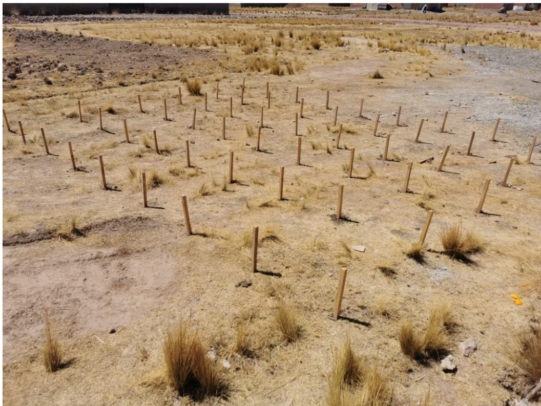
Anexo 2. 6 Cementerio de estacas para determinar el grado de resistencia
