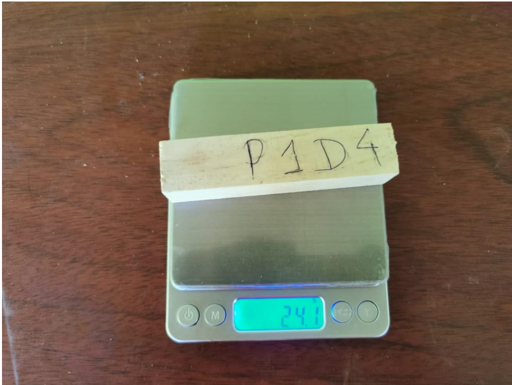
Anexo 2. 3 Pesaje para determinar la densidad básica
