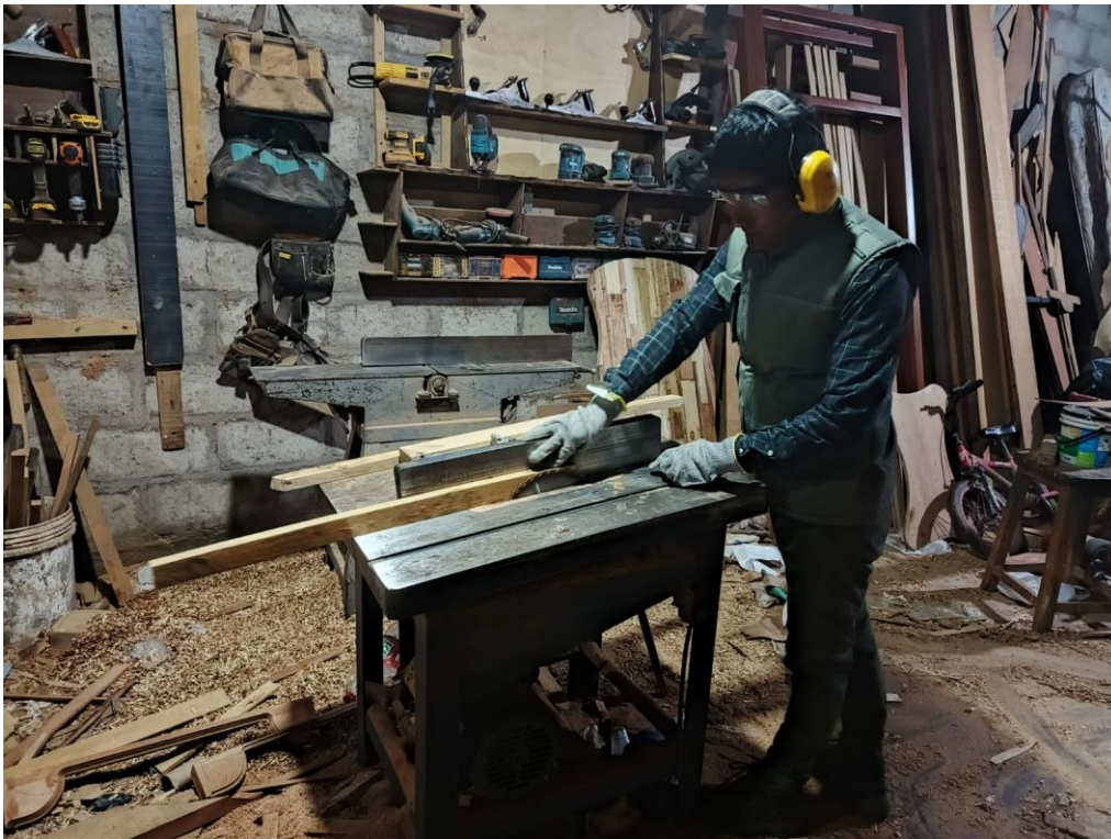
Anexo 1. 6 Corte longitudinal de las probetas de pino
