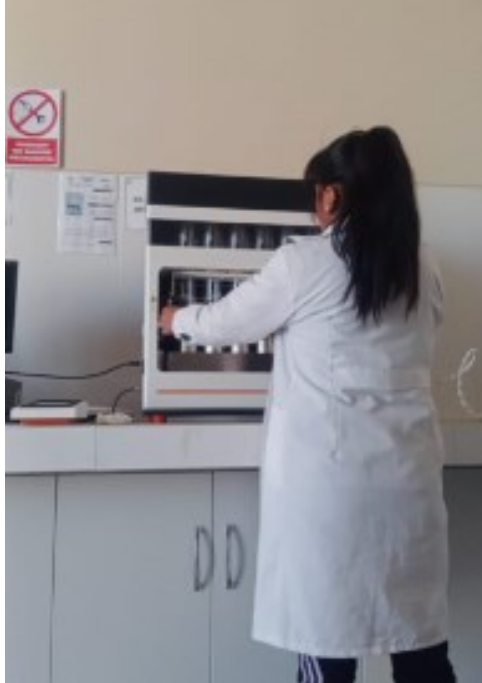
Figura 7: Extracción de Soxhlet
