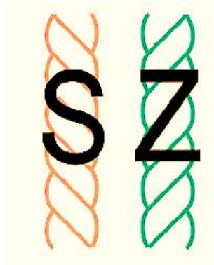
Figura 7. Sentido de torsión Z y torsión S en el hilado
