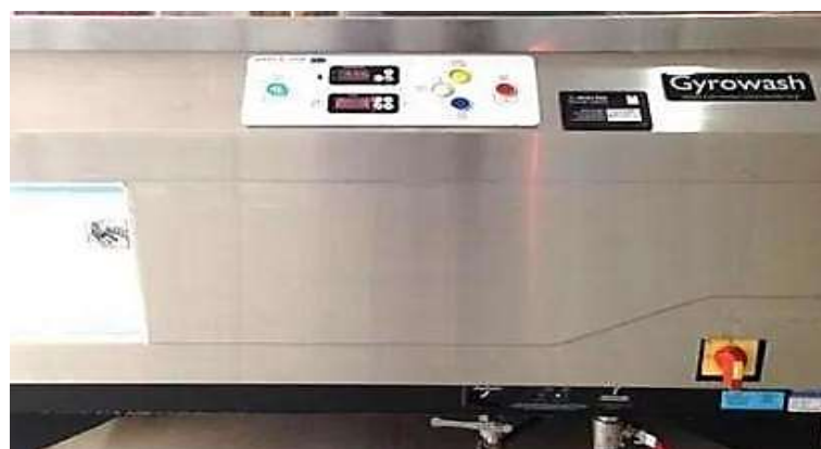
Figura 9: Máquina Gyrowash (lauderometro).
