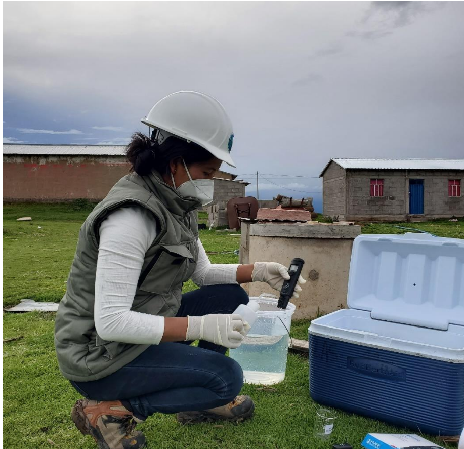
Figura 17. Desinfección del medidor de parámetros de campo
