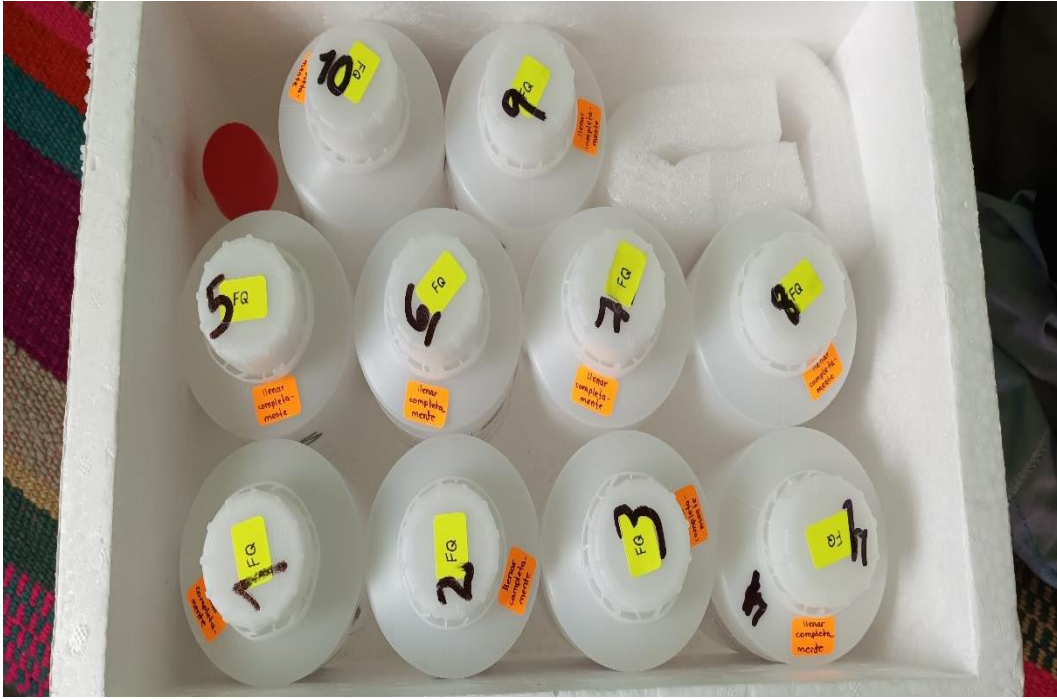
Figura 13. Preservación de las muestras para el envío al laboratorio
