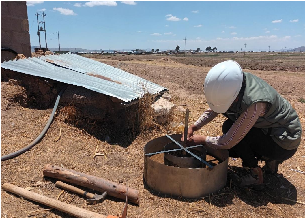
Figura 14. Medición de la capacidad de infiltración del suelo
