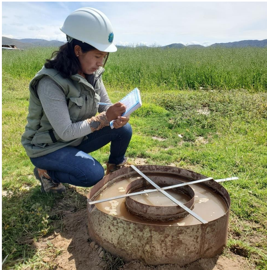
Figura 22. Registro de la capacidad de infiltración del suelo
