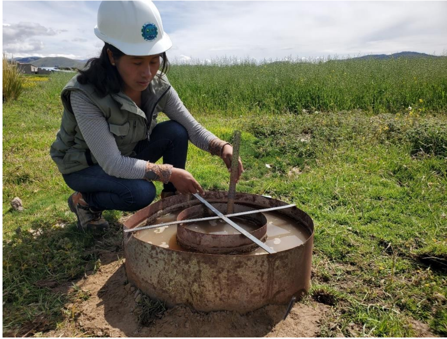
Figura 21. Medición de la capacidad de infiltración del suelo
