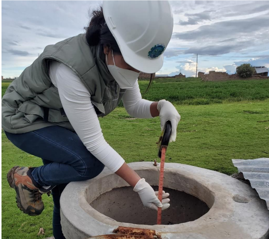
Figura 19. Medición del nivel freático en avenida
