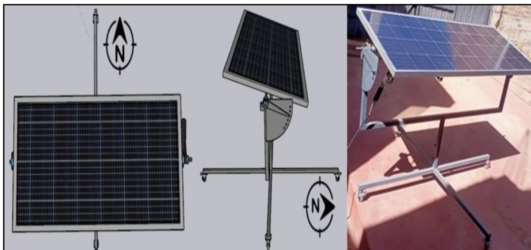
Figura 39. Orientación norte del sistema fotovoltaico.
