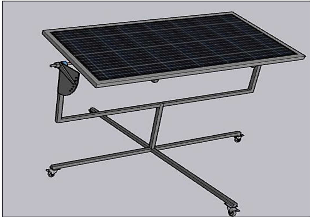
Figura 9. Diseño 3D de estructura de sistema fotovoltaico.
