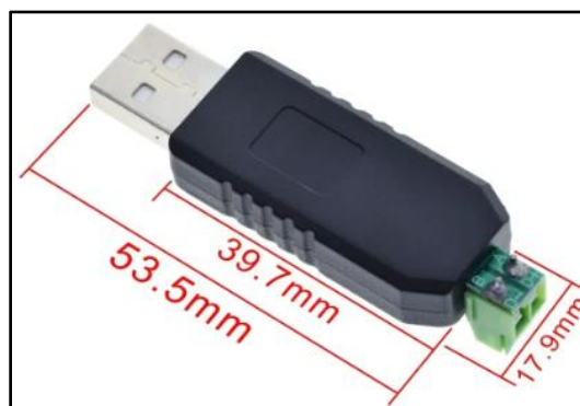
Figura 21. Dimensiones modulo convertidor RS485 a USB (Naylamp Mechatronics - Perú, 2023).
