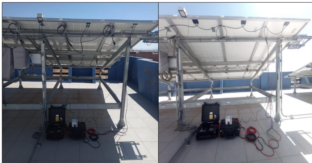
Figura 28. Trazado de curva I-V de un módulo fotovoltaico monocristalino.
