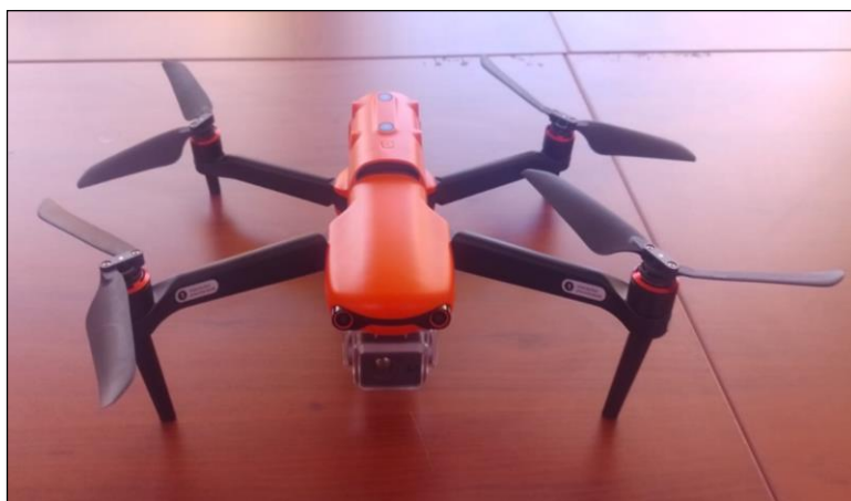
Figura 13. Dron con cámara termográfica.
