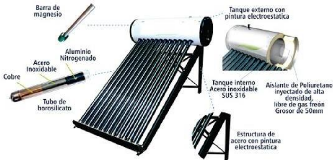
Figura 4.1: Componentes de un sistema térmico solar (Mendez J. &, 2011)
