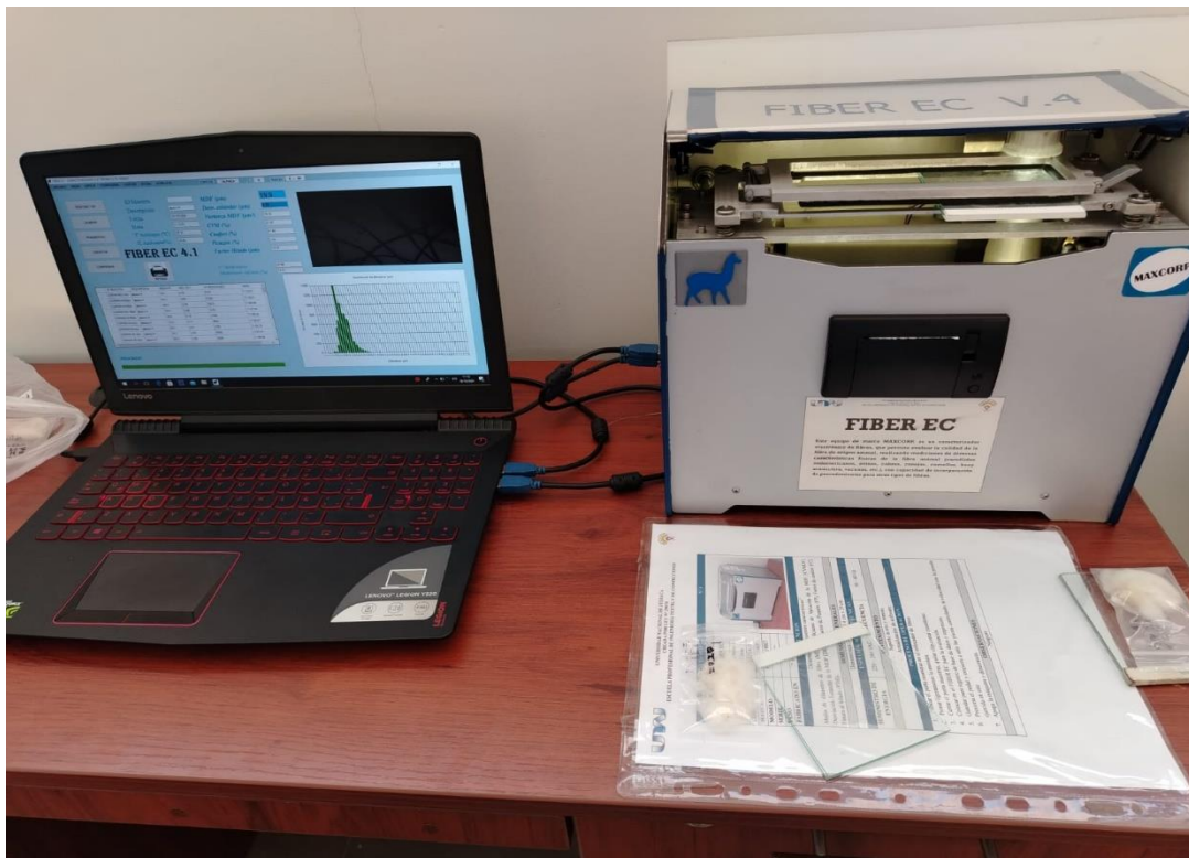
Nota: equipo FIBER EC V. 4, con la muestra insertada y la conexión con la laptop.
