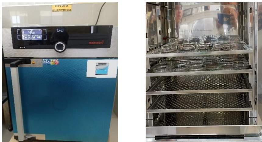
Figura 41: Los formulaciones en la estufa por 2 horas a 105 °C.
