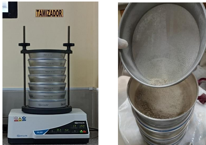
Figura 23: Proceso de tamizado de la harina de oca y quinua en un tamizador Retsch AS 200 Control.
