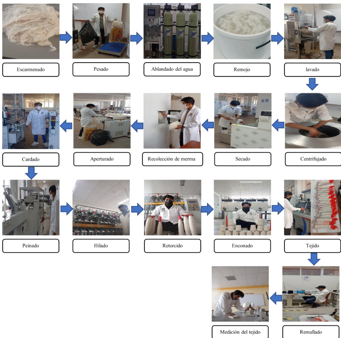
Figura 16: Diagrama de proceso de transformación de fibra a hilo y tejido.
