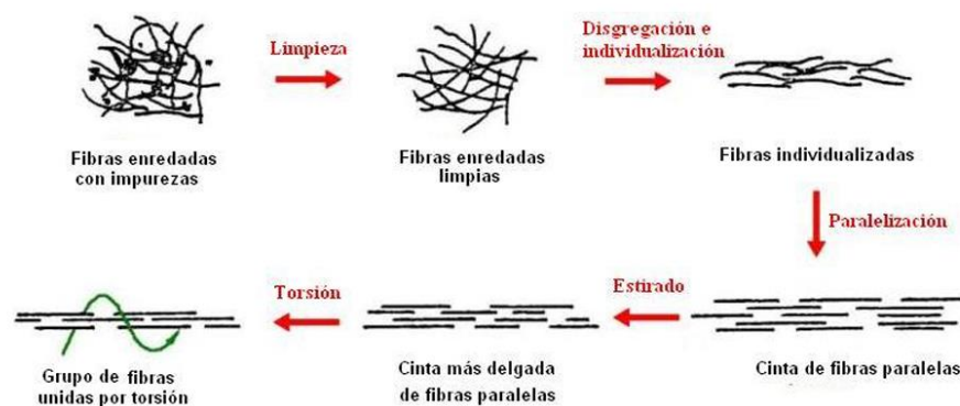
Figura 7: Proceso de hilado industrial.
