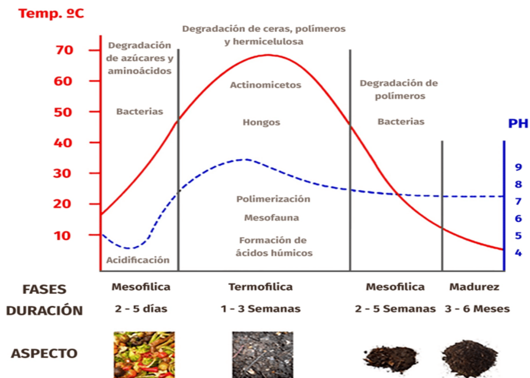
Figura 5. Temperatura, oxígeno, pH en el proceso de compostaje.
