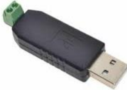
Figura 43. Módulo convertidor USB a RS485 (ELECTRONICS, 2024).
