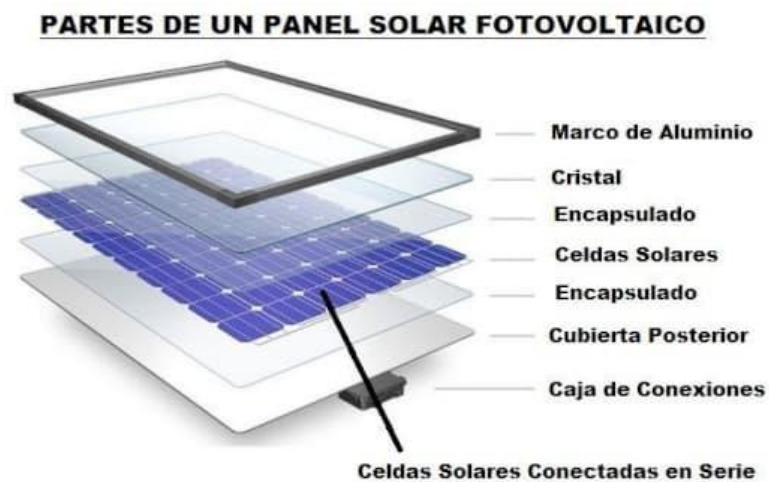
Figura 10. Módulo solar fotovoltaica convencional (Soliclima, 2019).
