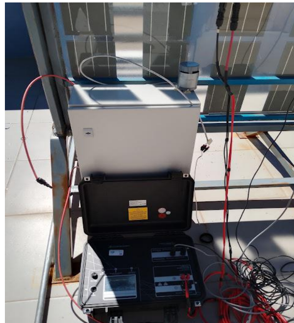
Figura 55. Realizando las pruebas con el trazador de curvas, sensor de radiación solar.
