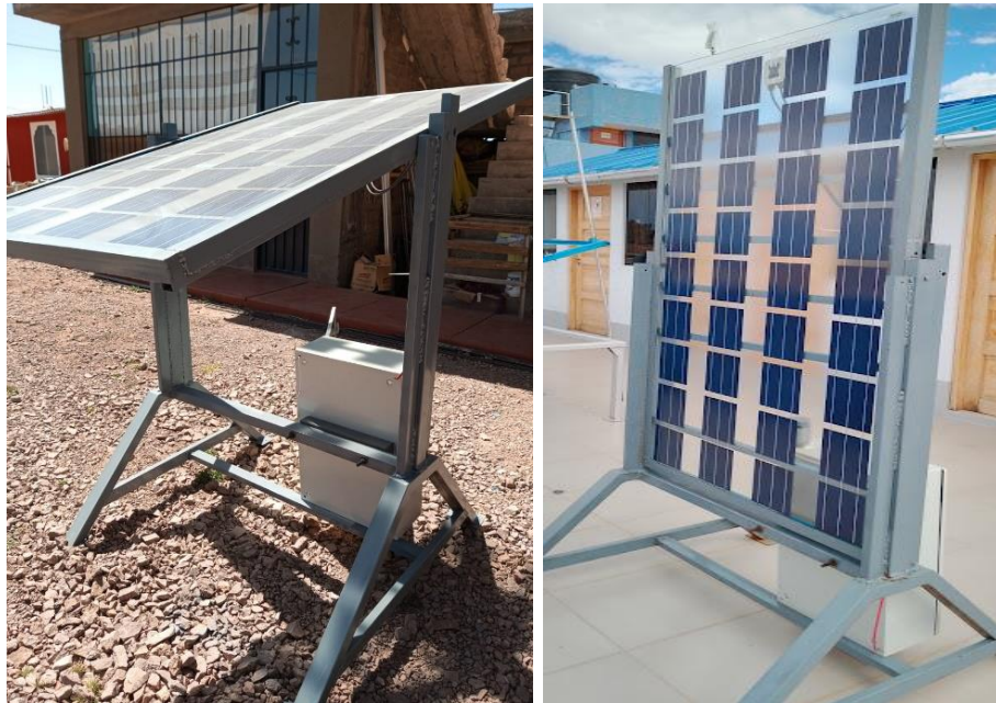
Figura 52. Montaje de módulo fotovoltaico a diferente grado de inclinación juntamente con el gabinete de adquisición de datos.
