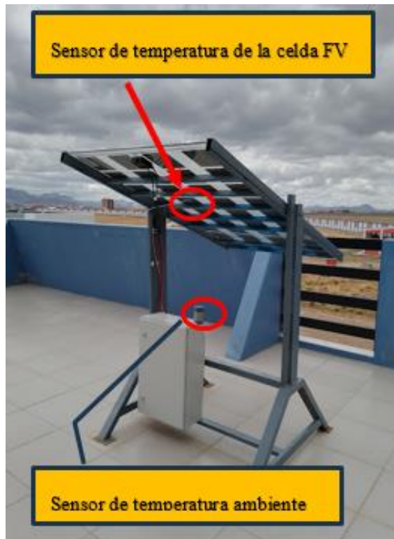
Figura 24. Ubicación de los sensores de temperatura de la celda fotovoltaica y temperatura ambiente.
