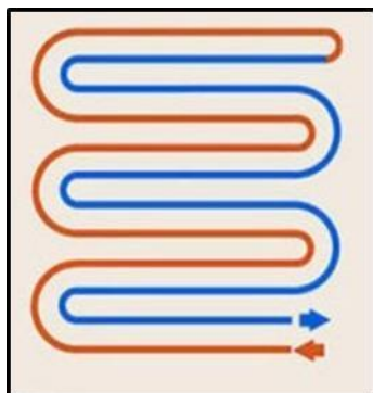
Figura 5. Distribución en doble serpentinado adaptado de Uponor (2017).
