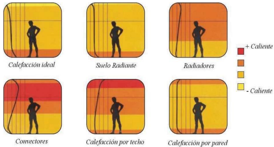
Figura 7. Distribución de temperatura en forma vertical del aire en función del sistema de calefacción (Diaz & Tinta, 2017).
