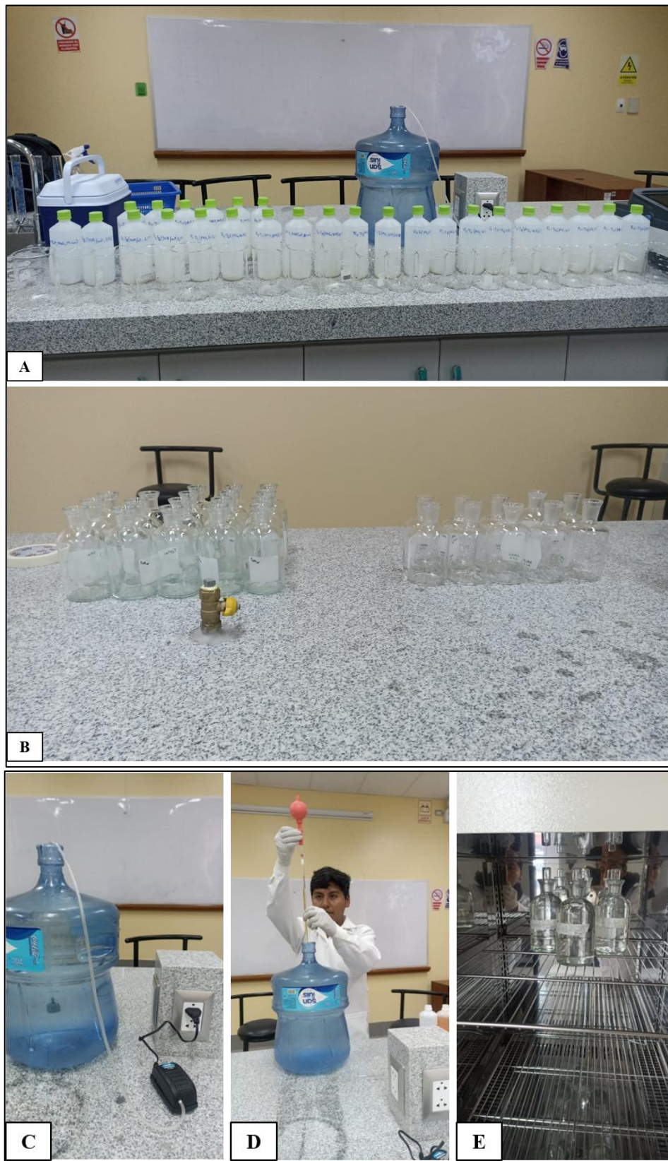
Figura 40. Determinación de la DBO 5 de las muestras de agua después del proceso de electrocoagulación A: Muestras de agua B: Frascos Winkler C: Aireación del agua de dilución D: Adición de reactivos E: Frascos Winkler en incubadora a 5 días
