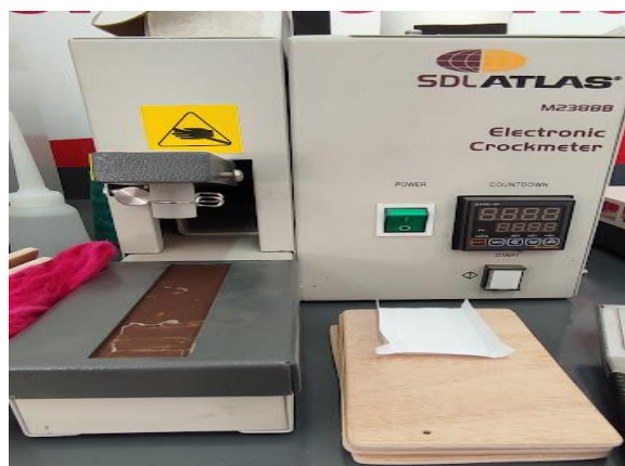
crockmeter electrónico de marca SDLATLAS M23888
