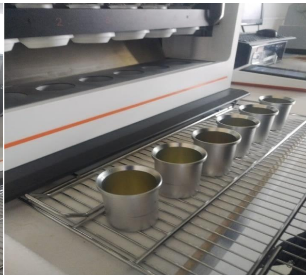
Proceso de extracción del aceite de semillas de uva mediante Soxhlet.
