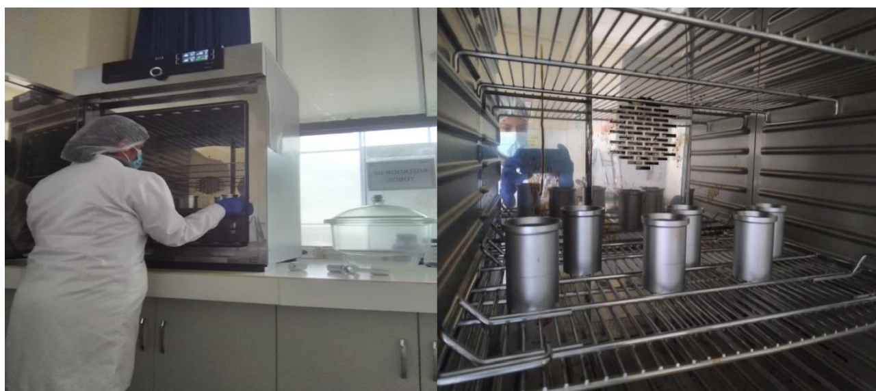
Evaporación del hexano en estufa a 40°C.
