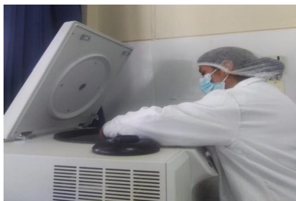
Centrifugado de las muestras de aceites extraídas por ultrasonido
