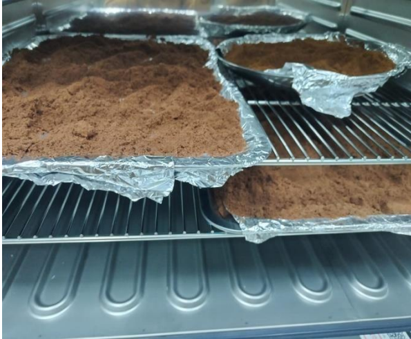
Secado en estufa de las semillas molidas.
