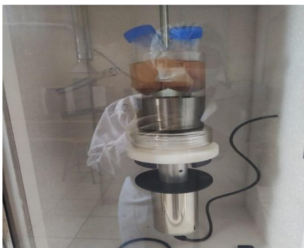
Extracción asistida por ultrasonido del aceite.
