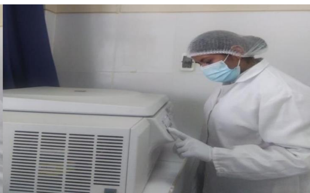
Centrifugado de las muestras de aceites extraídas por ultrasonido
