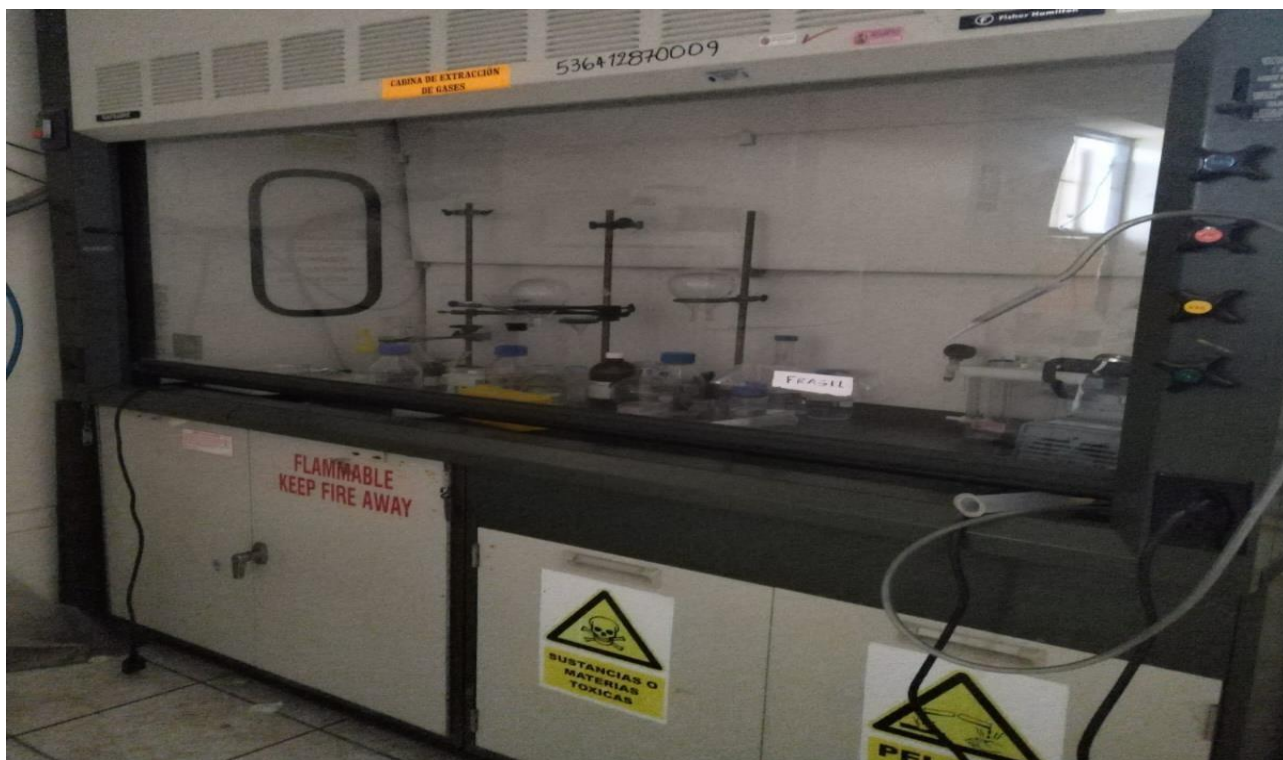
Cabina de extracción de gases, para separar la mezcla de solvente y soluto.
