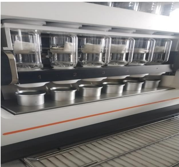
Proceso de extracción del aceite de semillas de uva mediante Soxhlet.
