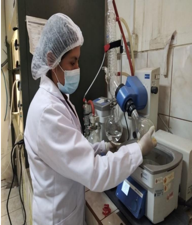
Colocando el balón con el contenido de hexano/aceite al rotavapor.
