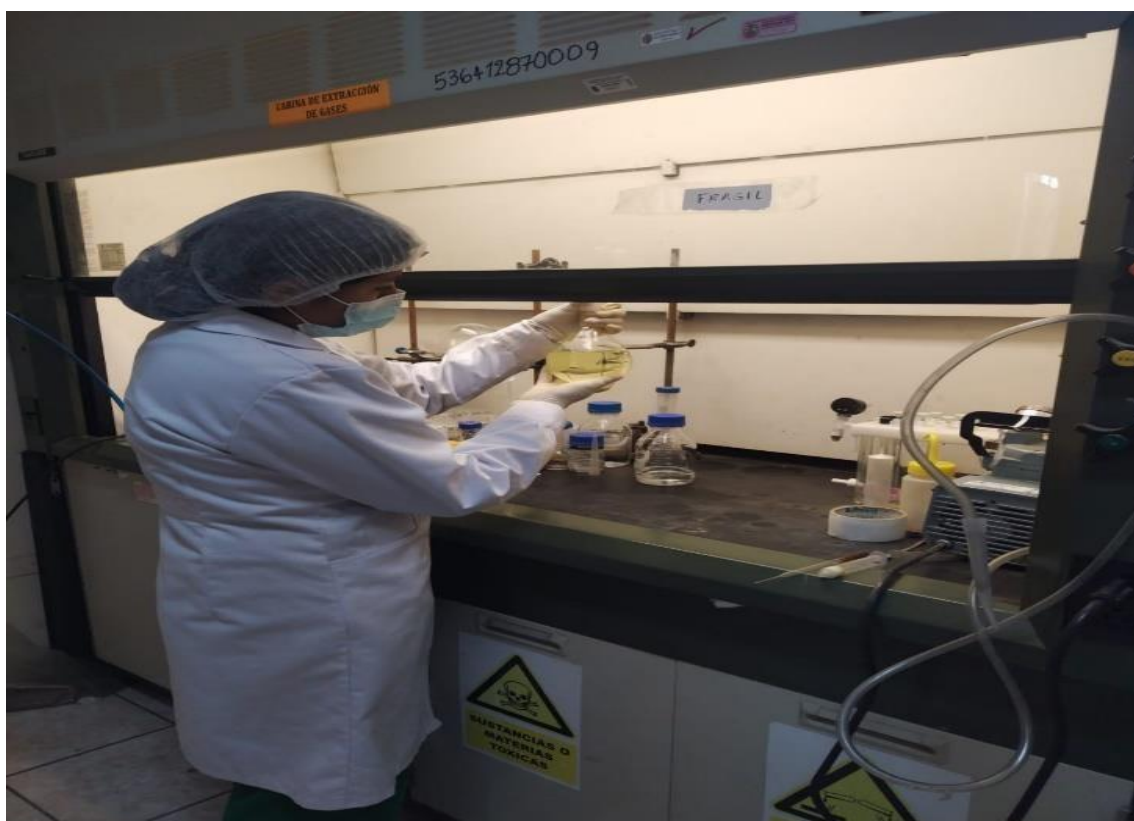
Proceso de separado de la mezcla hexano/aceite – semillas de uva, para empezar con la separación del hexano del aceite.
