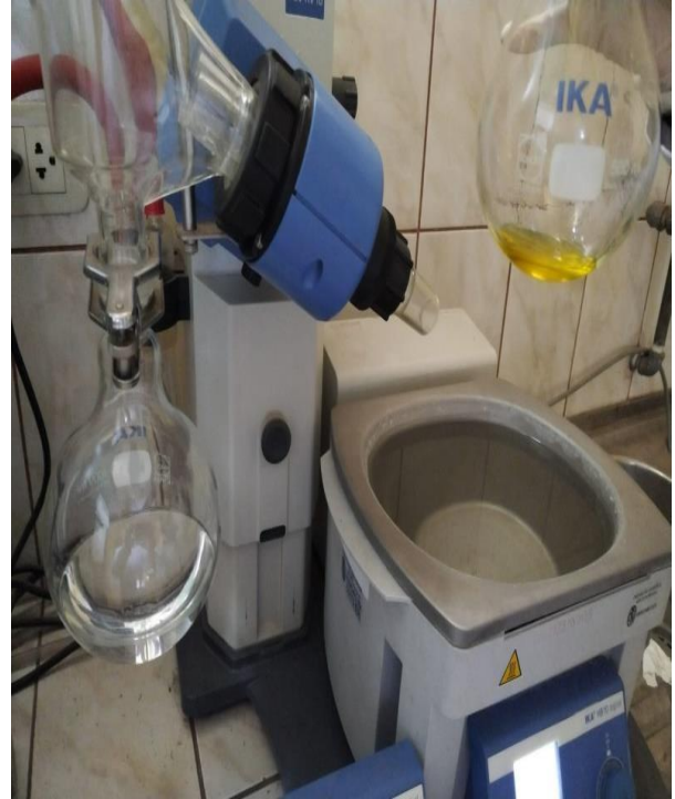
Aceite obtenido después de la separación del hexano.
