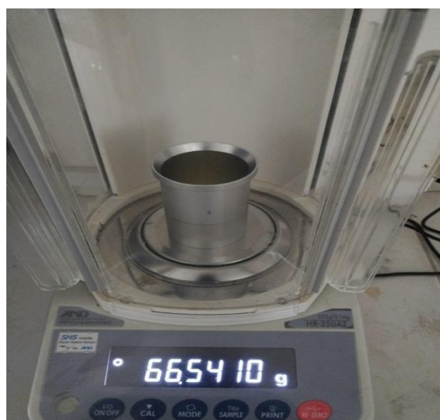
Pesado del aceite obtenido por soxhlet.
