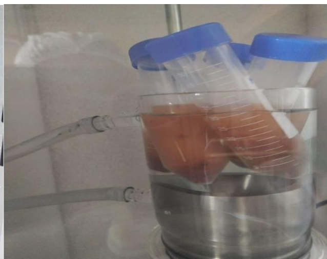
Extracción asistida por ultrasonido del aceite.
