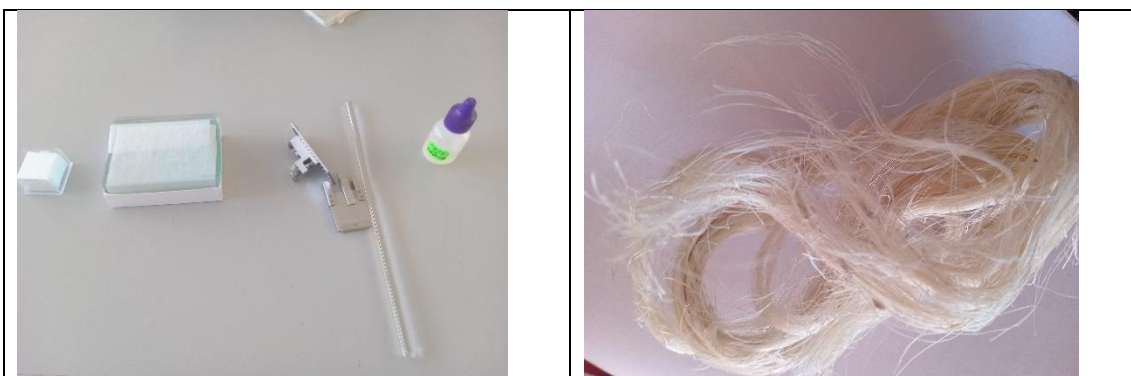
Imagen 20. Preparación de muestras para análisis de finura en laboratorio de fibras - UNAJ
