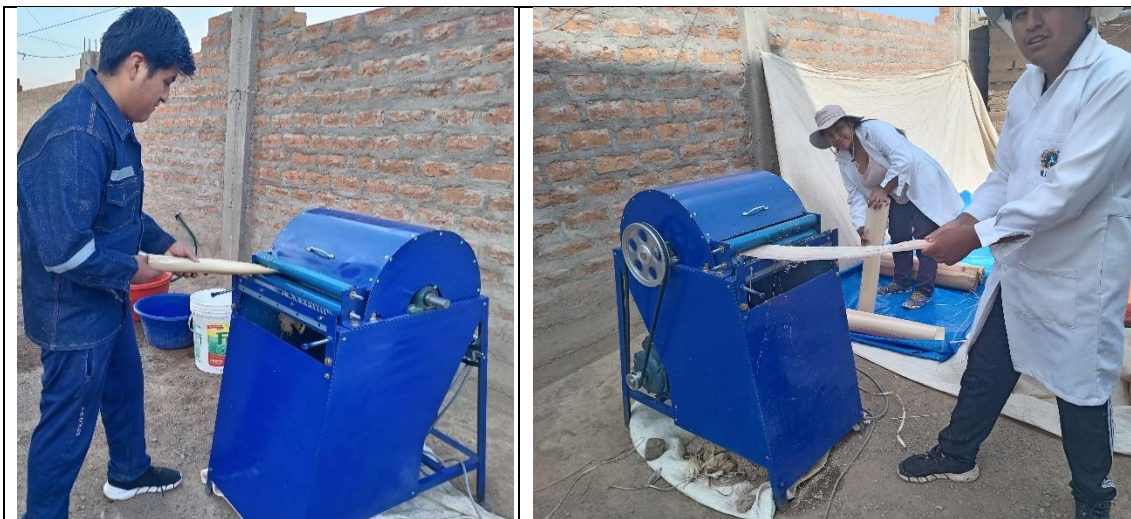
Imagen 8. Extracción mecánica de la fibra
